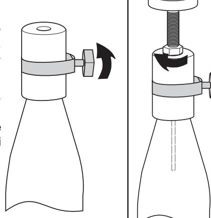
Drehen Sie den Logger nach rechts in den Flaschenadapter, bis die gewünschte Eintauchtiefe erreicht ist.
